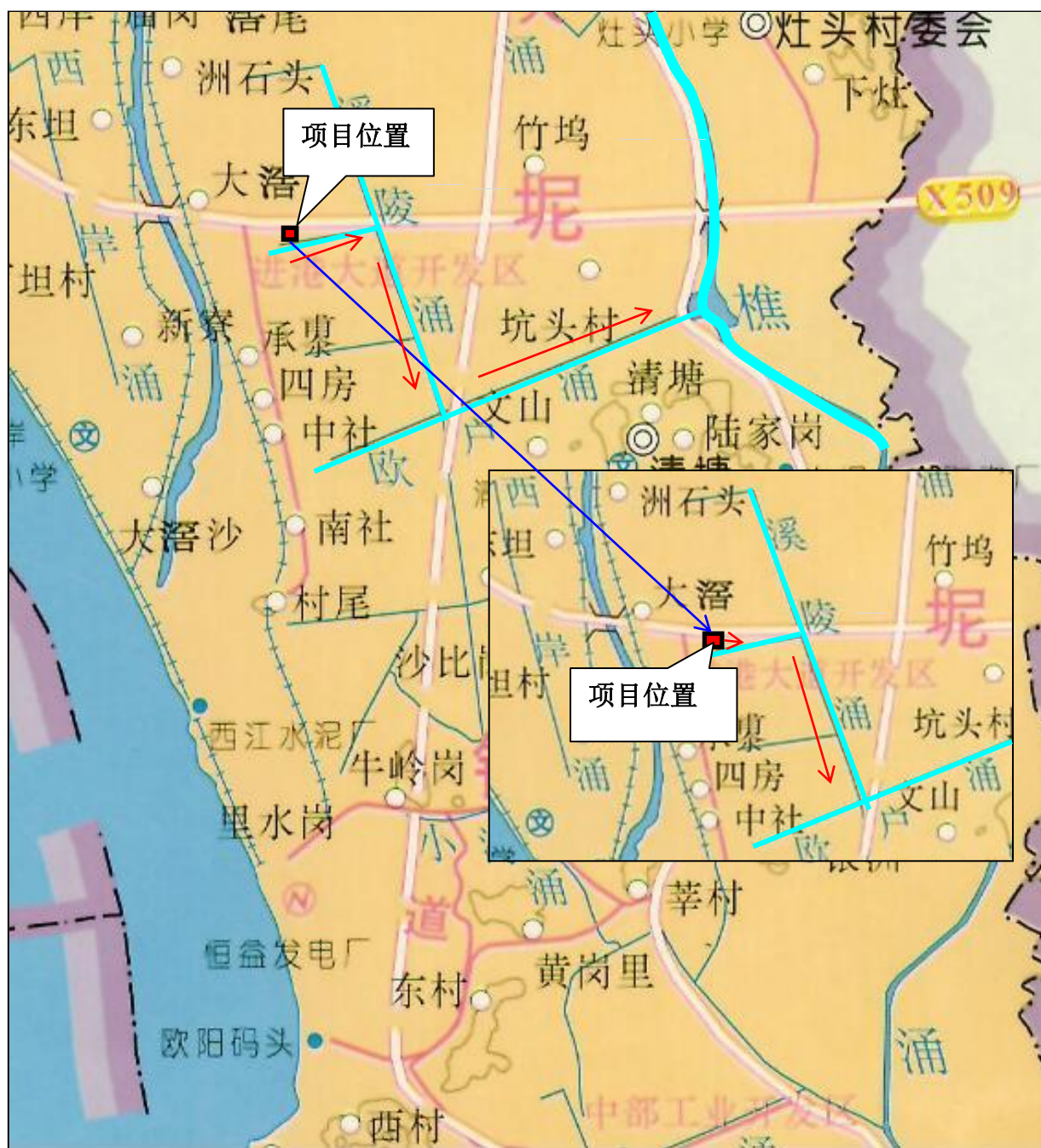
图 3.4-1 本项目事故废水外泄途径
